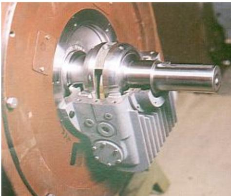
Figura 4.5.3. – Gerador linha S com mancal de bucha aberto para inspeção.
