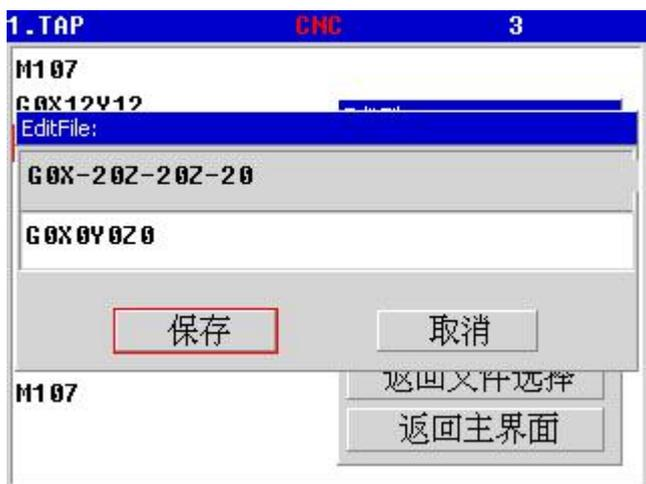
控制器面板上的相应键,输入所需的 G 代码,后按”OK”键,保存返回,(前端是旧的参数行),面板修键中有” ←”可以对输入出错的字符进行退位修改.
