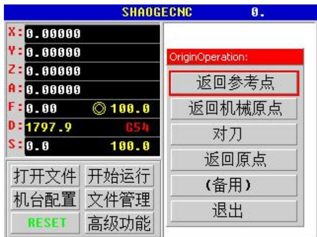
“返回参考点” Z 轴升到安全高度, 其它所有轴再回到指定的位置, Z 轴再回指定位置, (在机械原点上可以设定此点)
