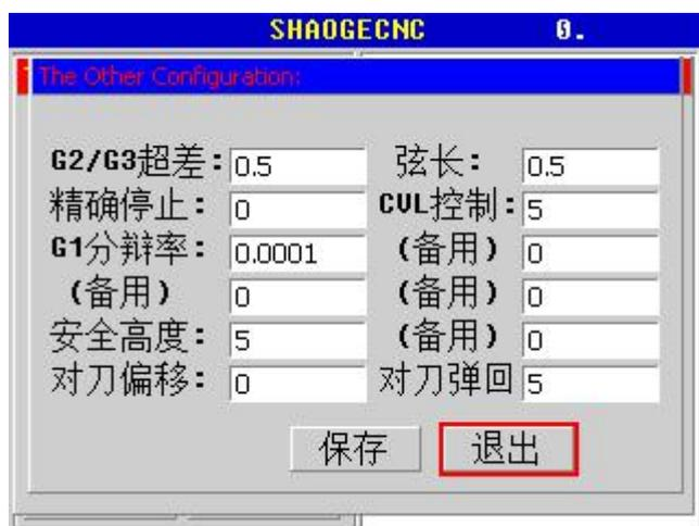
**G2/G3 超差:** 指手工计算或其它计算后输入 G02/G03.是因为计算精度问题,使之圆弧圆心跟给定的值不一致,此刻,有一个容错值,系统会根据给定的参数,重新计算最理想的圆心坐标,详述可见 G02/G03 说明
