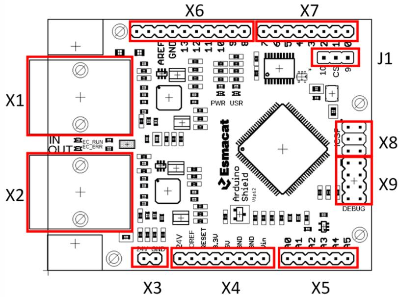
FIGURE 3. CONNECTORS AND JUMPER OF EASE
