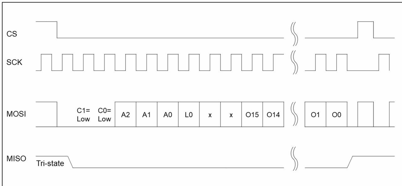
**FIGURE 16. SINGLE 16BIT DATA WRITE OF EASE VIA SPI**
