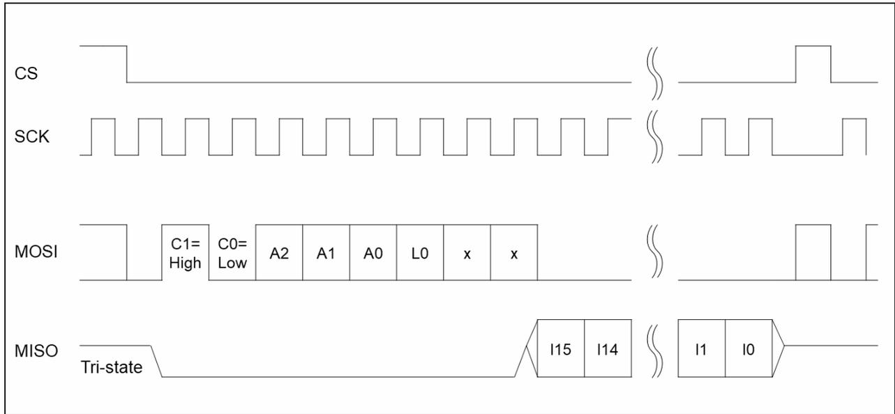
**FIGURE 15. SINGLE 16BIT DATA READ OF EASE VIA SPI**
