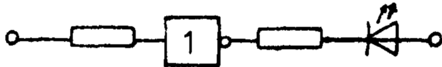
Abb. 13: Prinzip der Ansteuerung einer Leuchtdiode
