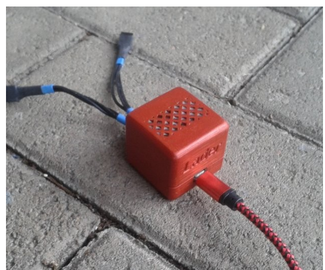
LiFePo4-USB-Lader im Gehäuse
