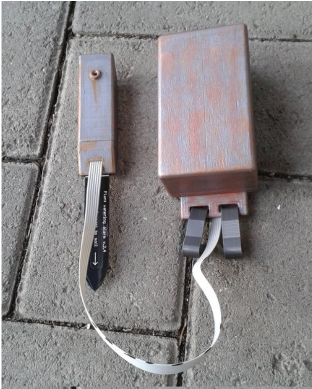
Planzen-Client mit Chirp-Sensor
