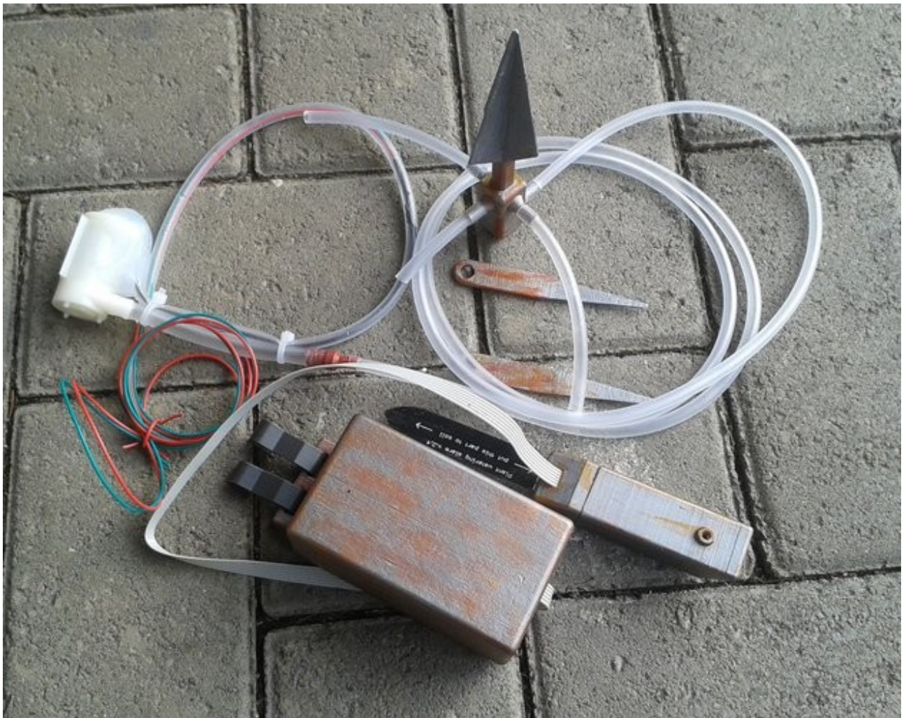
Kompletter Client mit Fühler, Pumpe und Schlauch
