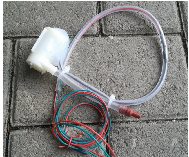
Tauchpumpe mit Anschluss und Schlauch
