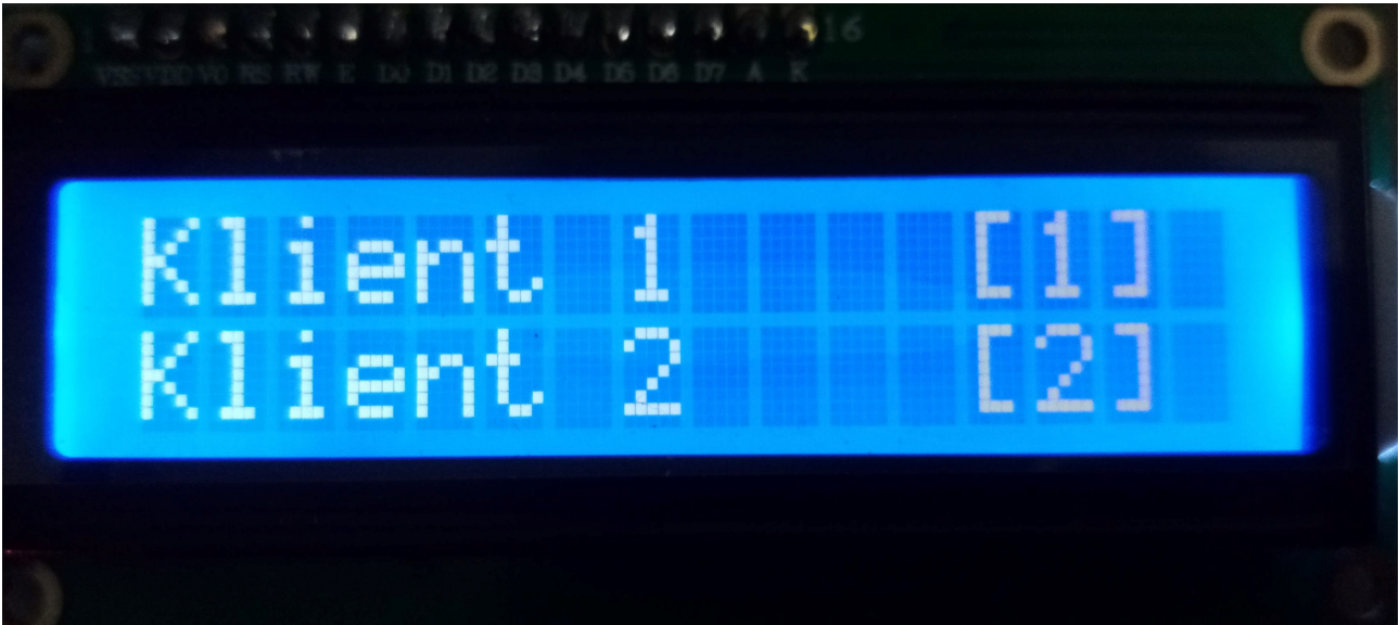
Zdjęcie 9. Wygląd menu serwisanta umożliwiającego mu odblokowywanie kart klientów.
