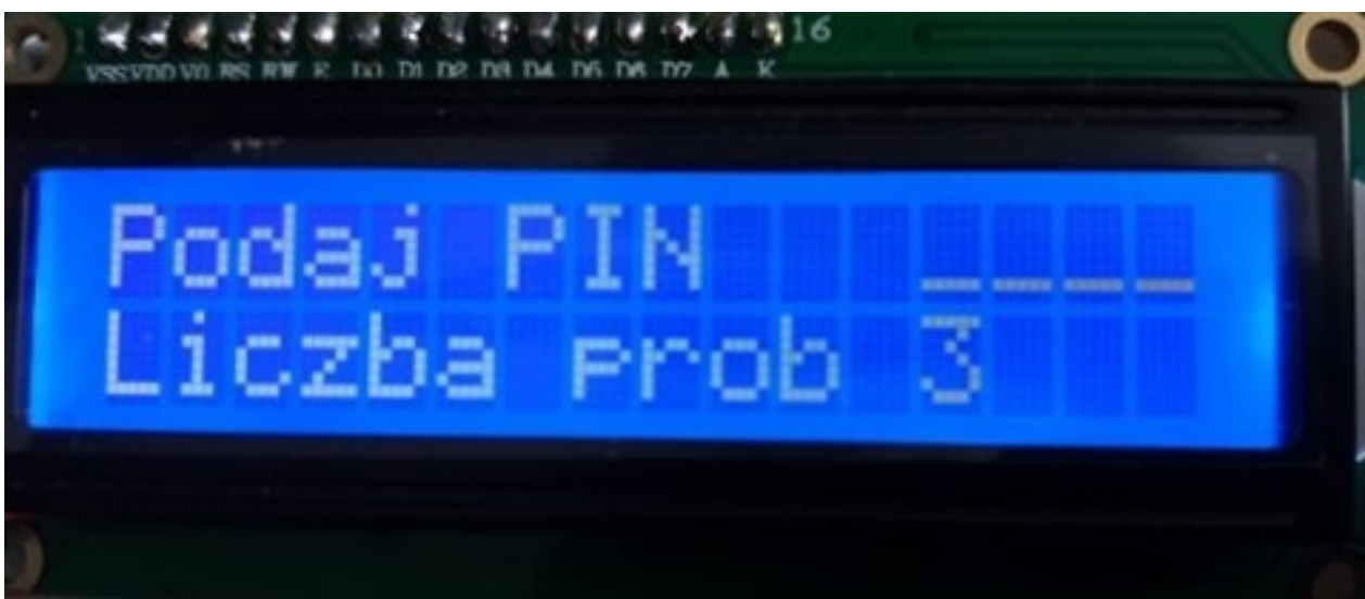
Zdjęcie 2. Wygląd menu umożliwiającego wprowadzenie kodu PIN.
