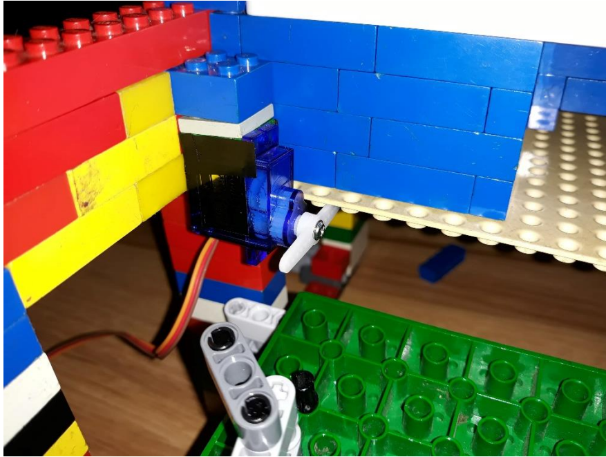
Rys. 2.11 Montaż serwo mechanizmu obsługującej zapadnię kulek z pojemników po sortowaniu.
