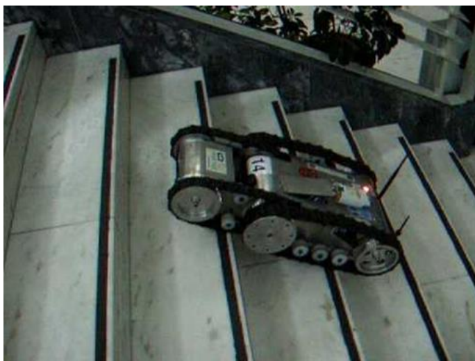
Rys. 1. Robot jednosegmentowy z przekładnią pasową [3].
