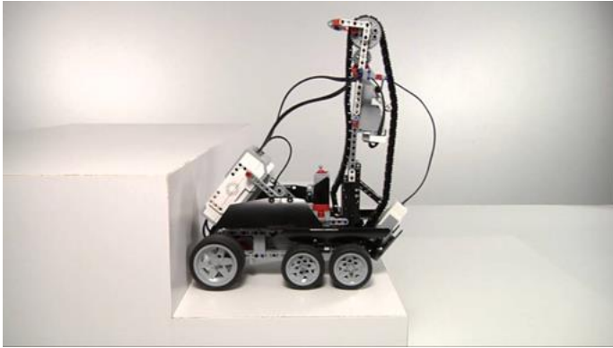
Rys. 2. Robot dwusegmentowy z przekładnią pasową [5].
