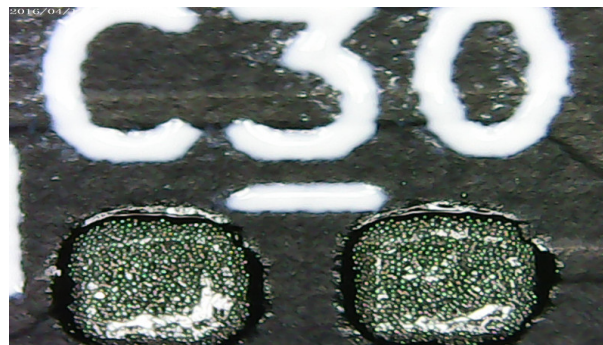
FIGURA 4.4: Pasta de soldar aplicada con stencil en huella de 0603 pulgadas.
