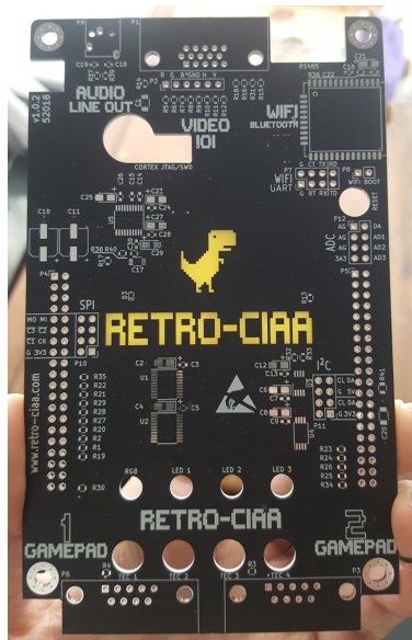
FIGURA 4.3: Foto del PCB fabricado. La imagen del T-Rex pertenece al proyecto Chromium, autor Sebastien Gabriel, licencia BSD 3-clause.
