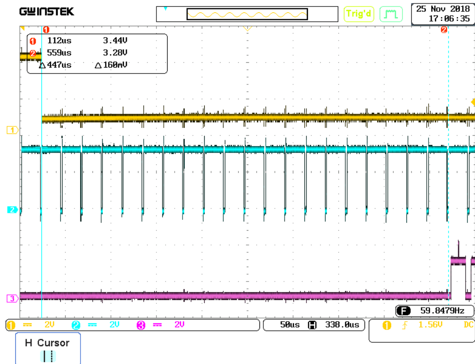
FIGURA 5.7: Duración del Vertical Back Porch de la señal VSsync(1). Se muestran señales Hsync(2) y componente R(3).
