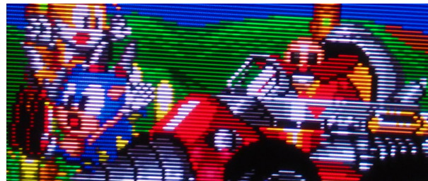
FIGURA 3.28: Efecto de «scanlines» de contenido 240p visualizado en un monitor CRT. Videojuego Sonic the Hedgehog 2 (1992) para consola SEGA Mega Drive.
