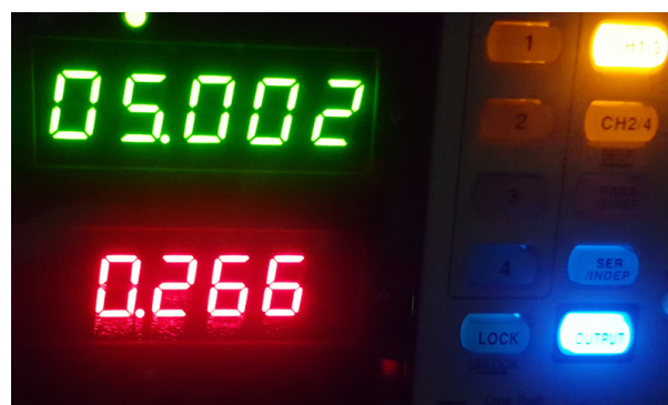
FIGURA 5.3: Consumo de corriente con alimentación de 5 V y modulo Wi-Fi apagado.
