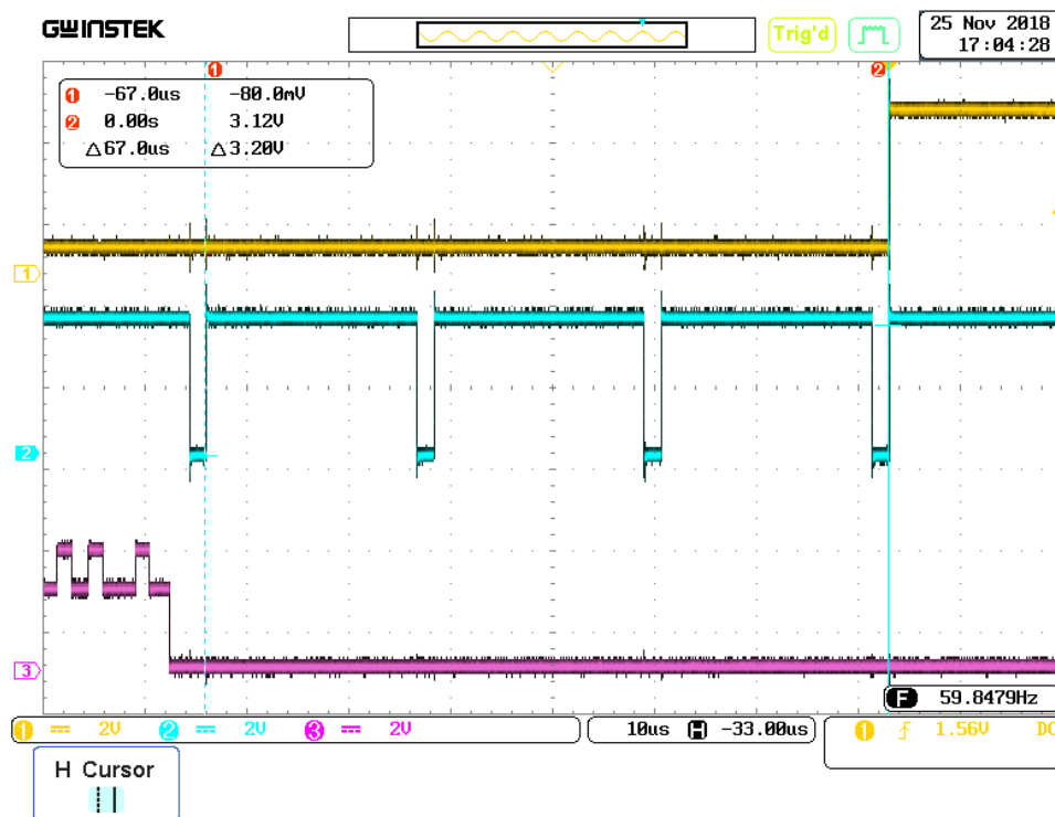
FIGURA 5.5: Duración del Vertical Front Porch de la señal VSYNC(1). Se muestran señales \overline{HSYNC} (2) y componente R(3).
