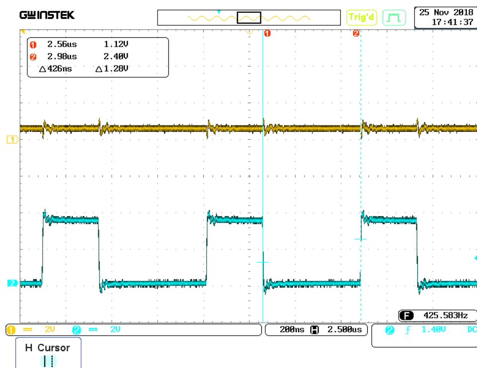
FIGURA 5.26: Medición de estado bajo de la señal de joystick para CLOCK(2).
