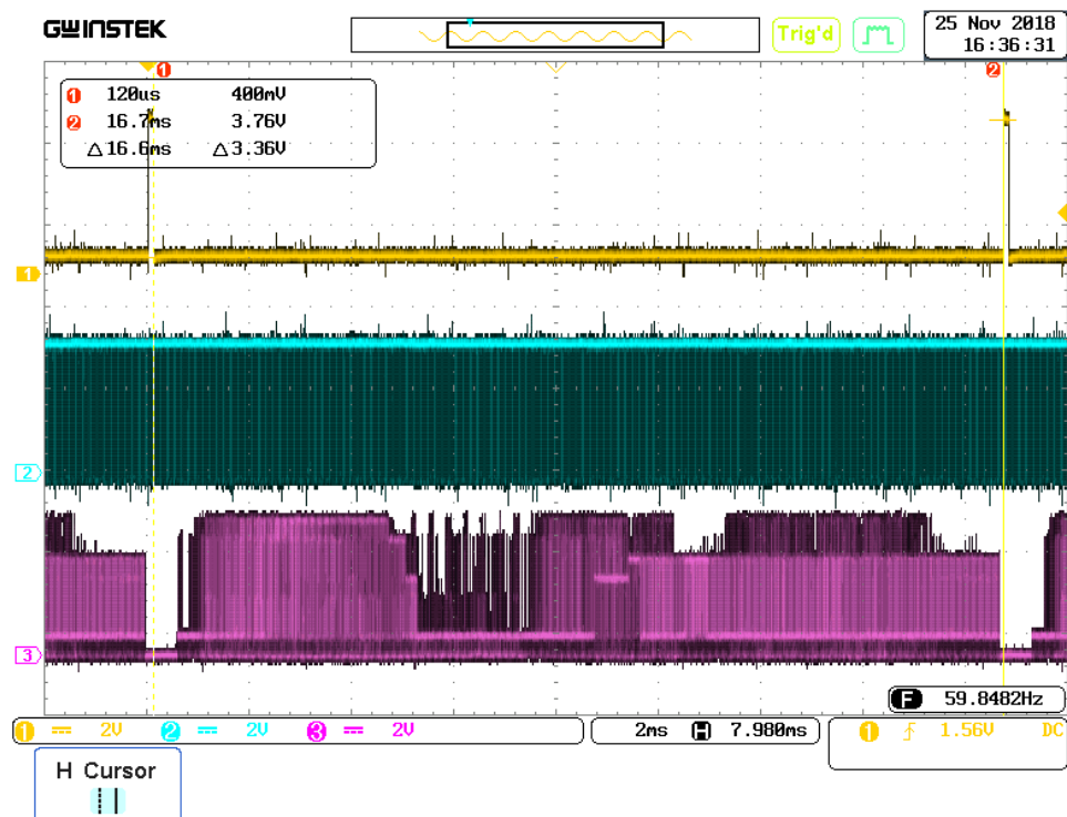
FIGURA 5.8: Duración de un cuadro de video en la señal VSsync(1). Se muestran señales Hsync(2) y componente R(3).
