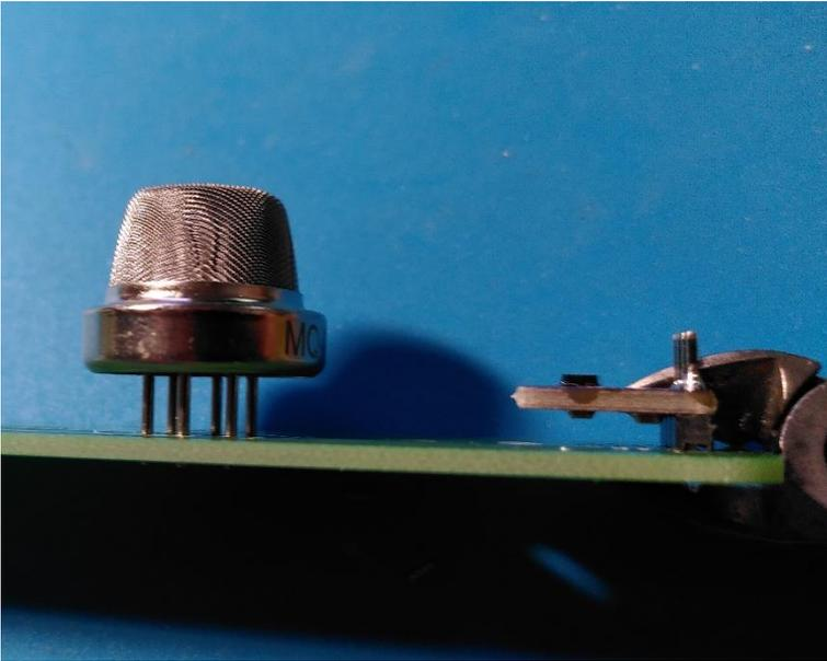
Der metallische Sensor sollte möglichst mit maximalem Abstand zur Platine eingelegt werden. Dennoch müssen die Beinchen am unteren Ende jedoch gut verlötbar sein!
