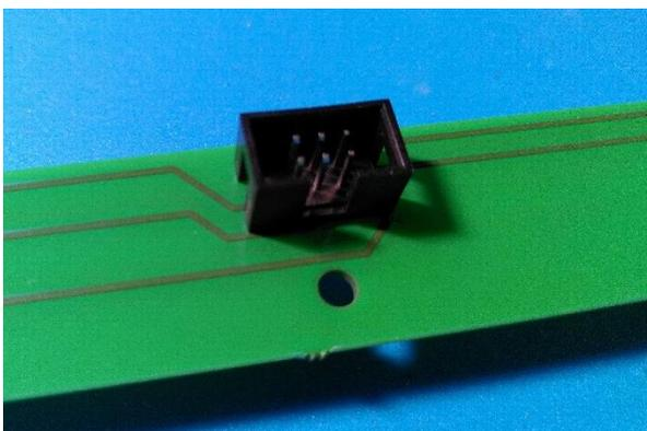
Im nächsten Schritt wird der 6-polige Wannenstecker auf der unbeschrifteten Platinen-Seite eingelötet.
