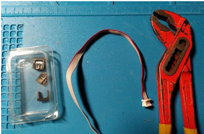
Der bestehende Stecker bei der X-Serie ist nicht mit der Ersatzplatine kompatibel. Durch wenige Handgriffe kann jedoch ein zweiter Steckverbinder angebracht werden.
