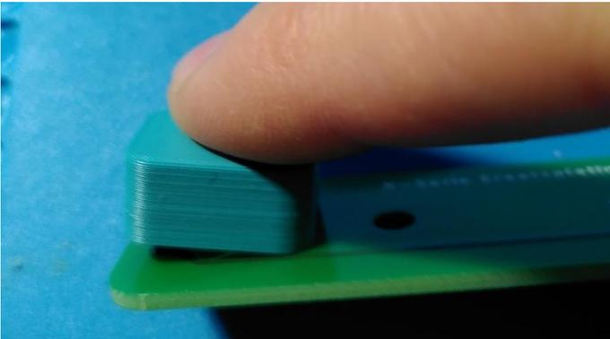
Die Abdeckkappen können ohne Kleber auf der Sensor-Platine platziert werden. Hierbei muss leichter Druck auf die Abdeckungsobenseite ausgeführt werden! Hierbei sollte vorsichtig vorgegangen werden und keine übermäßige Gewalt ausgeübt werden.
