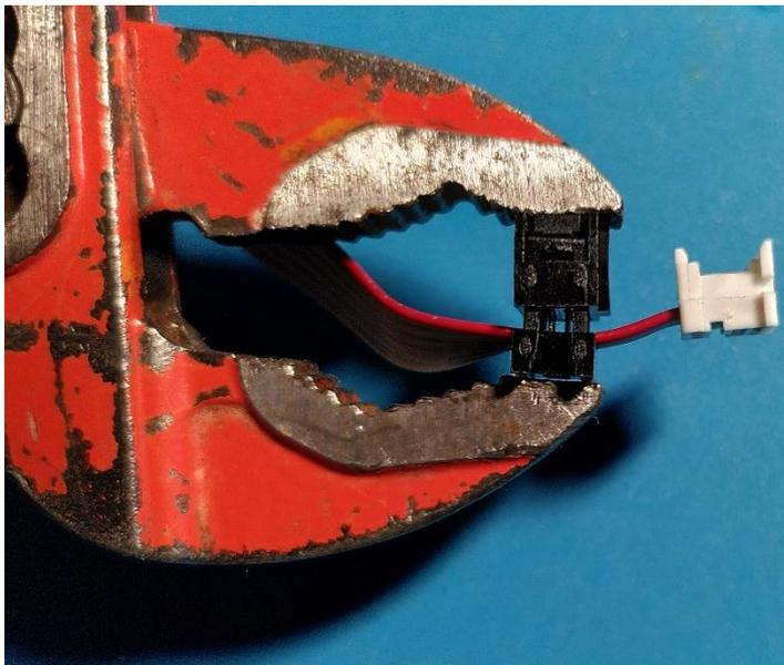
Wie im linken Bild ersichtlich muss das Kabel mit dem Wannenstecker umschlossen werden. Dies sollte möglichst Nahe am weisen Stecker erfolgen. Ideal ist ein Abstand von circa 1 cm.
