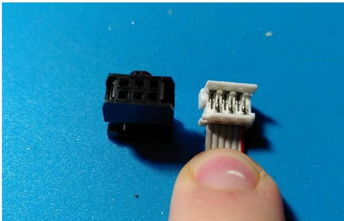
Die Nase des Wannensteckers muss immer zum Ende des Kabels zeigen. Ist die Orientierung wie im Bild, funktioniert der Sensor.
