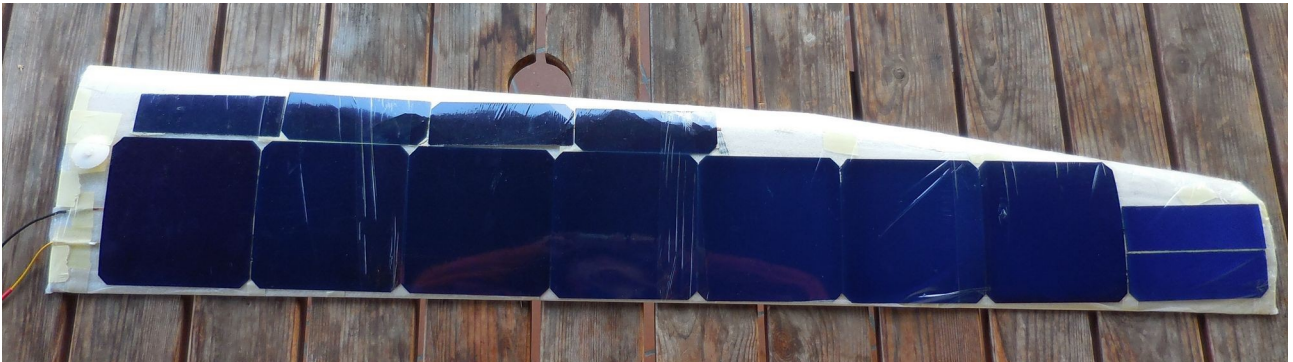
Abb. 15: Rechter Flügel, bespannt und mit Solarzellen belegt
