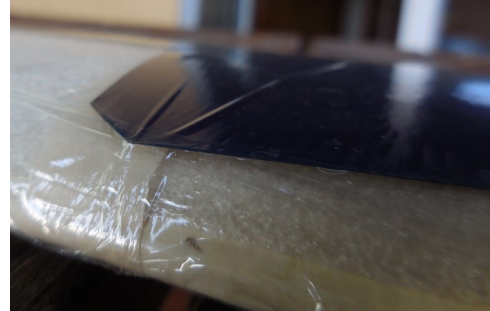
Abb. 17: Spalt zwischen Flügel und Solarzelle bei Bespannung
