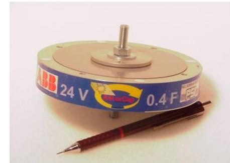
Os supercondensadores (ou ultracondensadores) têm uma densidade energética muito superior aos condensadores.
