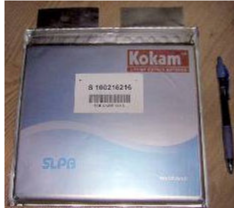
Figura 34: Bateria de lítio polímero Fonte: Kokam Battery
