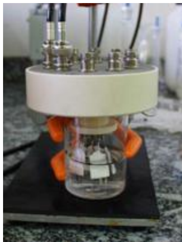
Figura 14 – “Língua Eletrônica” em funcionamento. Destaque para as unidades sensoriais mergulhadas na água. (Embrapa, 2006).
