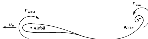
Figura 2.2: Circulação gerada por um perfil respeitando teorema de Kelvin
