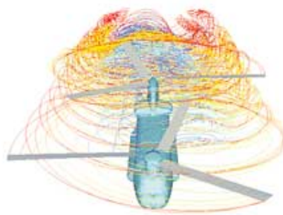
Figura 1.4: Esteira a interagir num rotor do tipo tandem [5]
