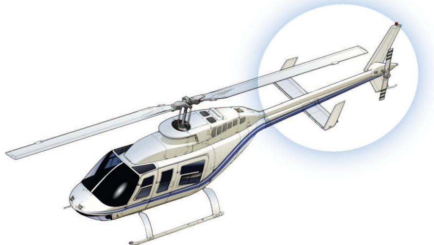
Figura 2.50 - Seção traseira Fonte: Westwind-helicopters, 2011. Adaptado pelo autor.
