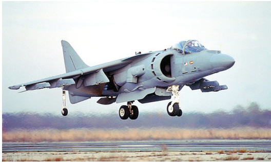
Figura 2.4 - Exemplo de avião STOL/VTOL de origem inglesa, atualmente fabricado pela americana Boeing – AV-8B Harrier II Plus Fonte: Boeing, 2011.
