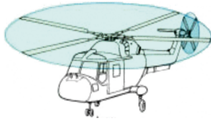
Figura 2.5 - Exemplo helicóptero rotor simples Fonte: Nomenclatura de Helicópteros, 2009.
