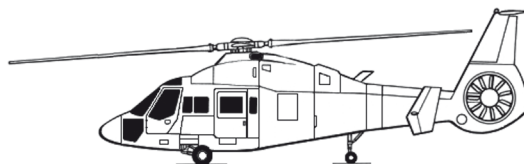
Figura 2.54 - Rotor de cauda do tipo Fenestron Fonte: Wikipedia, 2011.
