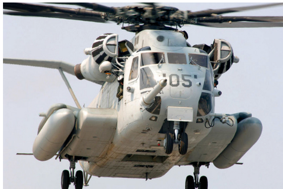
Figura 2.44 - Tanque sob suportes laterais Fonte: Scale-Rotors, 2011.
