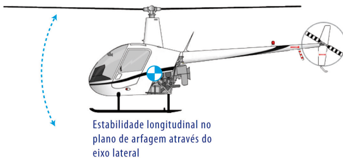
Figura 3.15 - Estabilidade longitudinal Fonte: Rocha (2009, p.95). Adaptada pelos autores.
