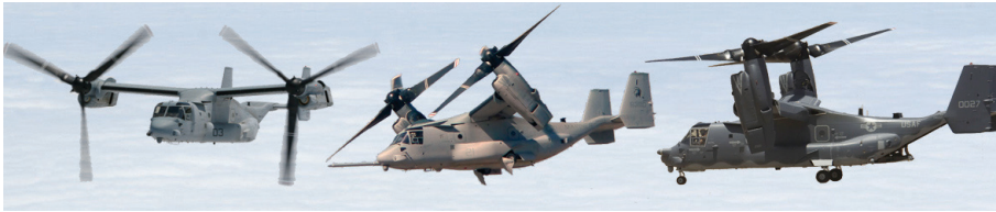
Figura 2.11 - Rotor de configuração variável Fonte: Target Lock, 2012. Adaptada pelos autores.
