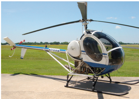
Figura 2.43 - Tanque de combustível visível Fonte: Airfliteok, 2011.
