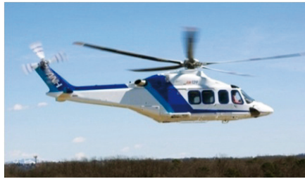
Figura 2.52 - Rotor de cauda do tipo convencional ou exposto Fonte: CAVOK Asas da Informação, 2010.
