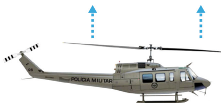
Figura 1.7 - Sustentação gerada pelo rotor principal Fonte: Howstuffworks, 2011. Adaptada pelos autores.
