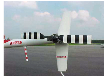
Figura 2.53 - Rotor de cauda do tipo convencional ou exposto Fonte: HowStuffWorks Brasil, 2012.
