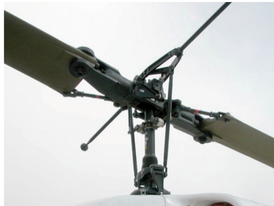
Figura 4.16 - Rotor semirrígido, bi-pá Fonte: USAFHPA, 2011.
