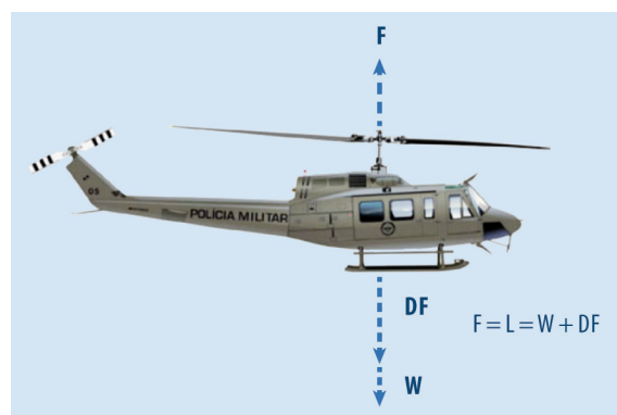
Figura 3.8 - Forças de sustentação do pairado sem vento Fonte: Aviação PRF, 2011. Adaptada pelos autores.
