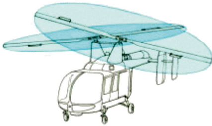
Figura 2.7 - Exemplo de helicóptero rotor contrarrotativo, lado a lado sincronizado Fonte: Nomenclatura de Helicópteros, 2009.
