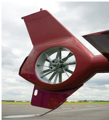
Figura 3.24 - Rotor tipo Fenestron Fonte: Flyheli, 2011.
