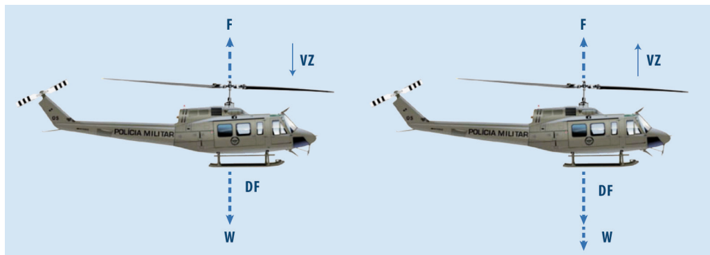
Figura 3.10 - Voo vertical Fonte: Aviação PRF, 2011. Adaptada pelos autores.
