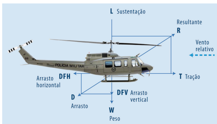
Figura 3.9 - Forças de sustentação do pairado com vento Fonte: Aviação PRF, 2011. Adaptada pelos autores.
