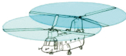
Figura 2.6 - Exemplo de helicóptero rotor em tandem Fonte: Nomenclatura de Helicópteros, 2009.
