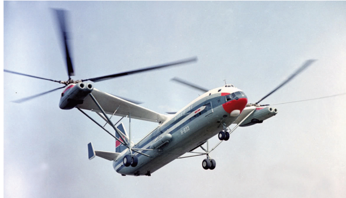
Figura 2.10 - Exemplo de rotor tipo duplo lado a lado não sincronizado Helicóptero russo – Mil Mi 12 Fonte: Gigantes do Mundo, 2011.
