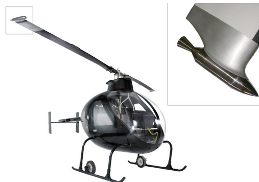
Figura 2.9 - Exemplo de rotor tipo jato Fonte: I Look Forward to, 2010. Adaptada pelos autores.
