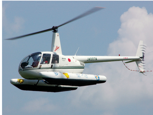
Figura 2.47 - Exemplo de helicóptero equipado com flutuadores Fonte: Helicópteros, 2011.
